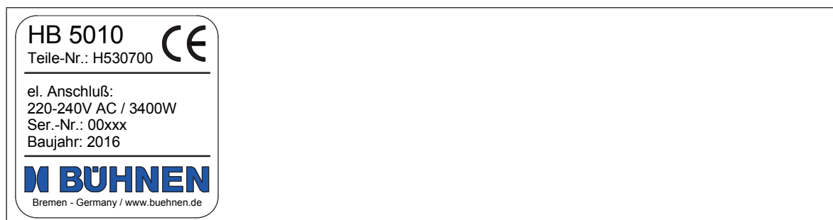
Obr. 2/1: Typový štítek na přístroji (příklad)
