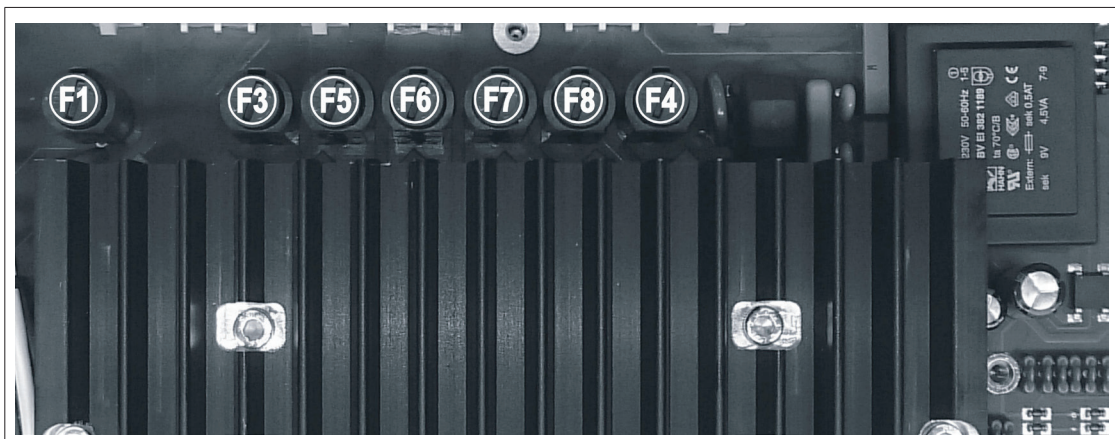
Obr. 8/8: Umístění pojistek na výkonové části
