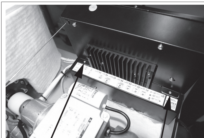
Obr. 8/2: Otevření řídicí jednotky
